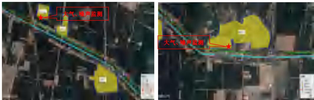
图 8-2 施工期大气、噪声监测点位布置图
